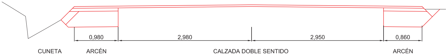
PK 0+020 SECCIÓN TIPO AMPLIACIÓN DE CALZADA
