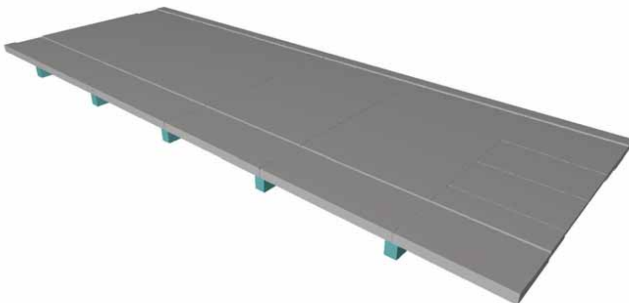
Figura 2.- Representación infográfica del modelo de láminas realizado para el dimensionamiento del puente.
