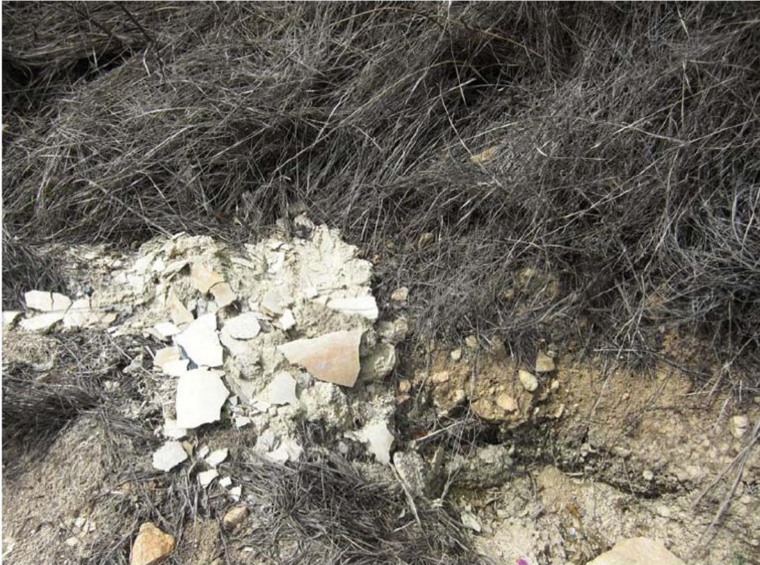
*Imagen 3: Formación de cal extraída del interior de la tubería*
