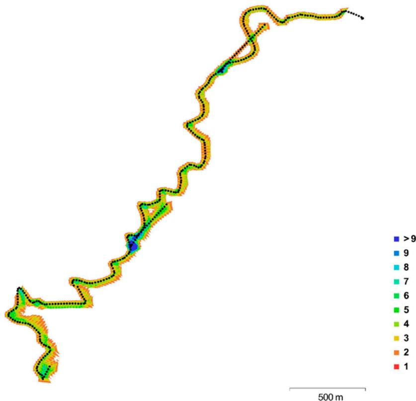
Fig. 1. Posiciones de cámaras y solapamiento de imágenes.
