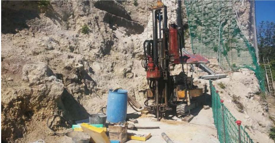
Fotografía 1: Vista de la sonda durante la realización del Sondeo S-1.
