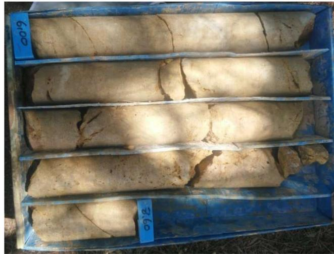
*Fotografía 4: Testigo continuo del sondeo 1, profundidad entre 6,00 y 9,00 metros.*
