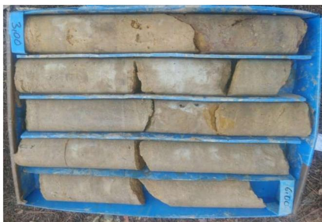
Fotografía 3: Testigo continuo del sondeo 1, profundidad entre 3,00 y 6,00 metros.
