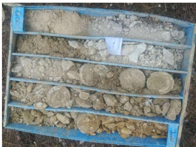
Fotografía 2: Testigo continuo del sondeo 1, profundidad entre 0,00 y 3,00 metros.
