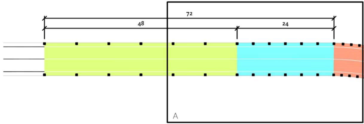
NOTA: Sólo serán balizadas con captafaros las curvas en las que el conductor tenga que reducir su velocidad en al menos 30Km/h, es decir las de grado 2 (panel doble) y las de grado 3 (panel triple).
