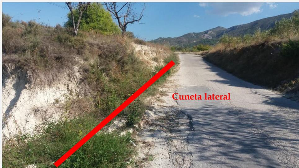
**Foto 05. Ubicación Pk 0+304.** Borde lateral del camino degradado. Se proyecta ejecución de cuneta lateral de hormigón en forma de V de 1,1 m de anchura.
