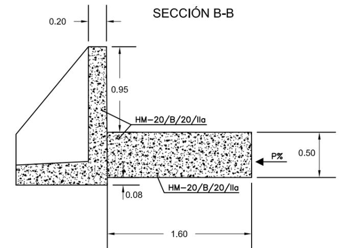
DETALLE EMBOCADURA TUBO EXISTENTE (COTAS EN mm)
