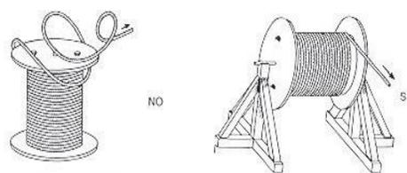
Debe evitarse que el rollo ruede por el suelo a fin de que no se produzcan adherencias de polvo o arena que actuarían como abrasivos y obligarían a una limpieza y posterior engrase, antes de su utilización. Igualmente no debe recibir golpes o presiones que provoquen raspaduras o roturas de los alambres. Deben protegerse de las temperaturas elevadas, que provocan una pérdida del engrase original.
