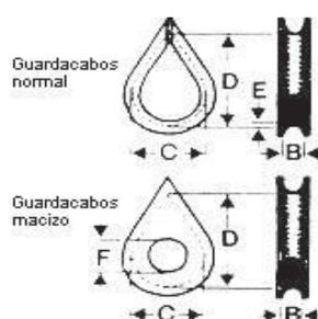
Los diagramas muestran dos tipos de guardacabos: 'Guardacabos normal' y 'Guardacabos macizo'. El guardacabos normal tiene una forma de gota con un pico, y el macizo es más ancho y plano. Las dimensiones B, C, D, E y F se indican con líneas y flechas para especificar las proporciones de cada parte del dispositivo.
