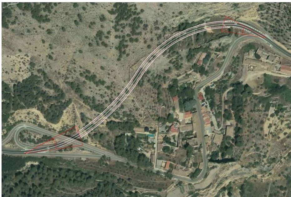
IMAGEN Nº 1.- Vista en planta del trazado del Túnel del Salt y los conos de visión antes descritos.
