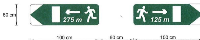
IMAGEN Nº 4.- SEÑALIZACIÓN DE LAS SALIDAS DE EMERGENCIA MÁS PRÓXIMAS
