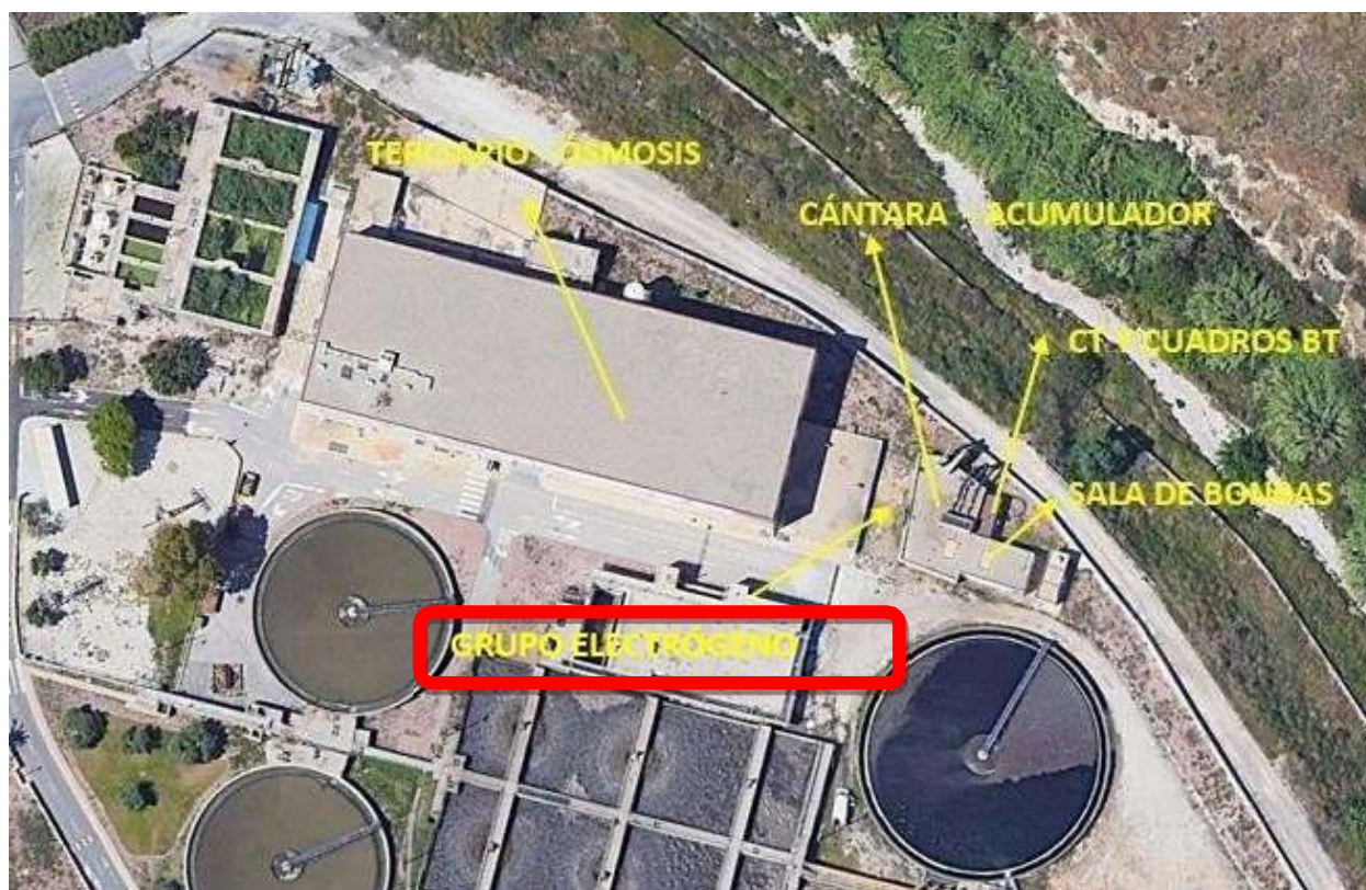
Ilustración 3. Ubicación del Grupo electrógeno en la EDAR de Rincón de León
