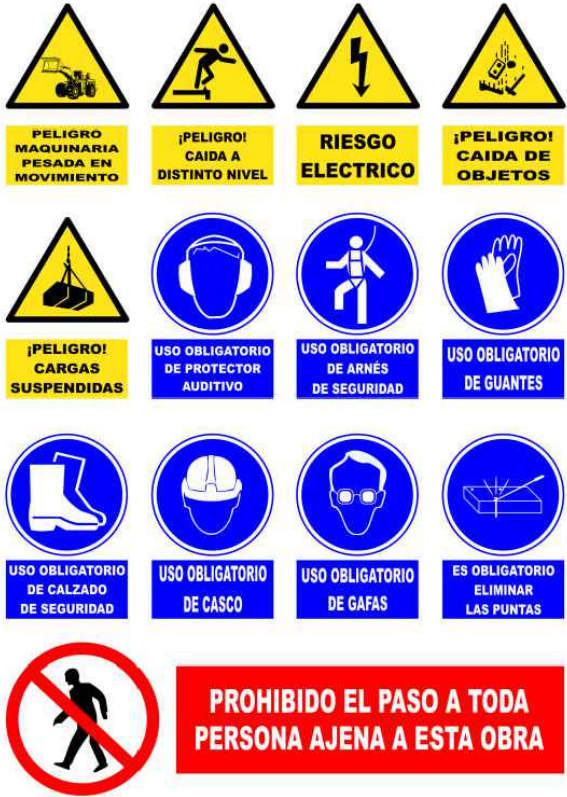
CARTEL PRECAUCIONES OBRA
