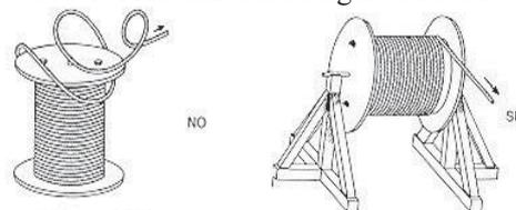
Debe evitarse que el rollo ruede por el suelo a fin de que no se produzcan adherencias de polvo o arena que actuarían como abrasivos y obligarían a una limpieza y posterior engrase, antes de su utilización. Igualmente no debe recibir golpes o presiones que provoquen raspaduras o roturas de los alambres. Deben protegerse de las temperaturas elevadas, que provocan una pérdida del engrase original.
