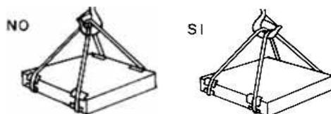
Antes de la elevación completa de la carga, se deberá tensar suavemente la eslinga y elevar aquélla no más de 10 cm para verificar su amarre y equilibrio. Mientras se tensan las eslingas no se deberán tocar la carga ni las propias eslingas.
