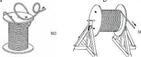
Debe evitarse que el rollo rueda por el suelo a fin de que no se produzcan adherencias de polvo o arena que actuarían como abrasivos y obligarían a una limpieza y posterior engrase, antes de su utilización. Igualmente no debe recibir golpes o presiones que provoquen raspaduras o roturas de los alambres. Deben protegerse de las temperaturas elevadas, que provocan una pérdida del engrase original.
