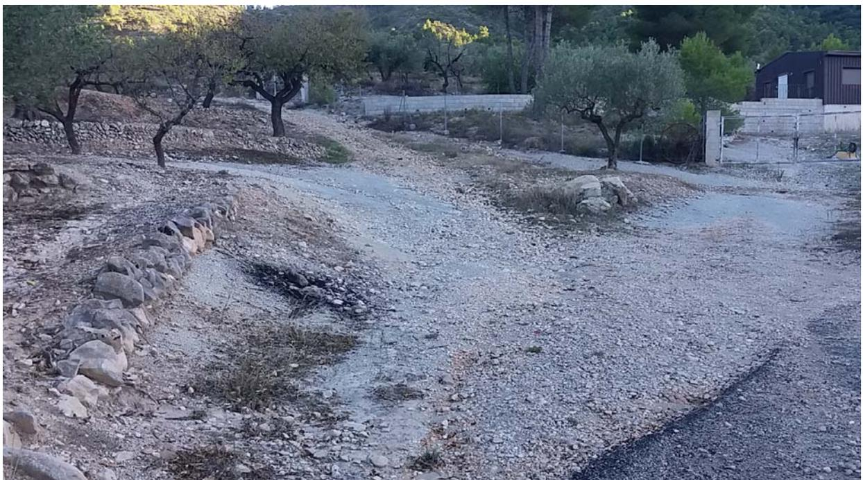
El camino existente que sube por el centro de la imagen es el tramo "Vinyes 5" donde se proyecta cajear y terraplenar una base para el pavimento de hormigón con mallazo.
