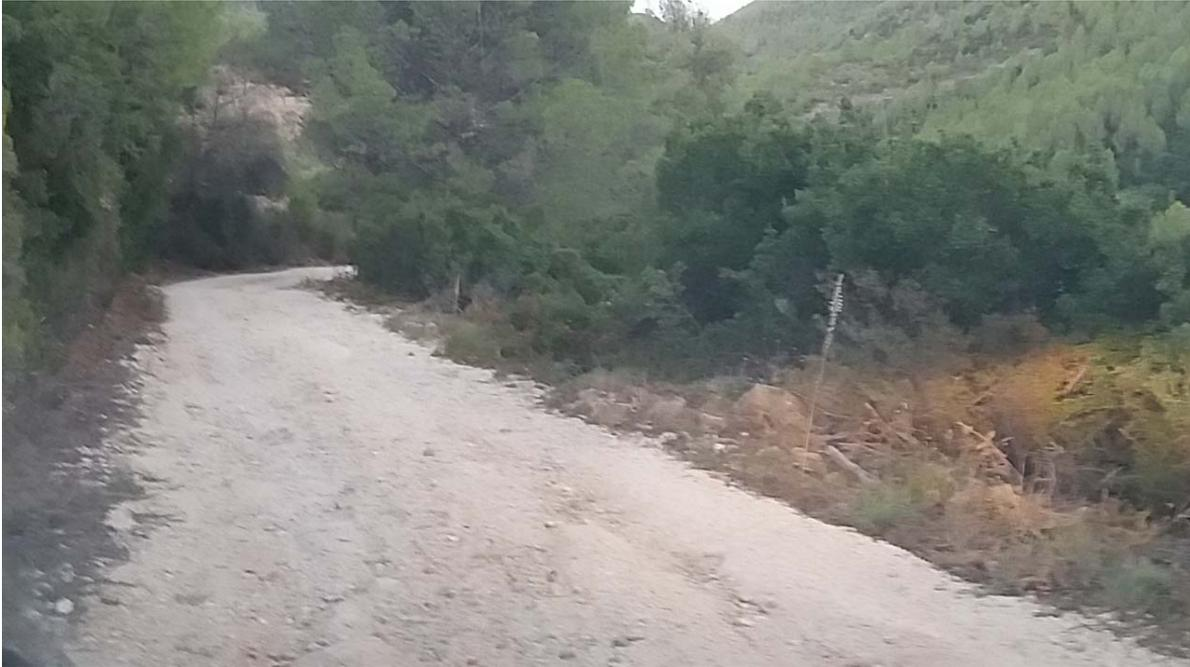
Único tramo afectado del camino "Font del Major", se efectuará un barrido mecánico para posteriormente ejecutar una solera de hormigón con mallazo, misma solución a aplicar en los tramos "Fortins 2" y "Fortins 3".
