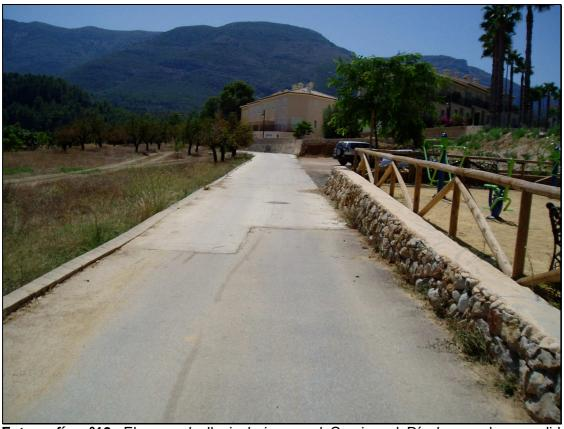
Fotografía nº10: El agua de lluvia baja por el Camino al Río buscando su salida natural, por eso un tramo presenta pavimentación de hormigón.
