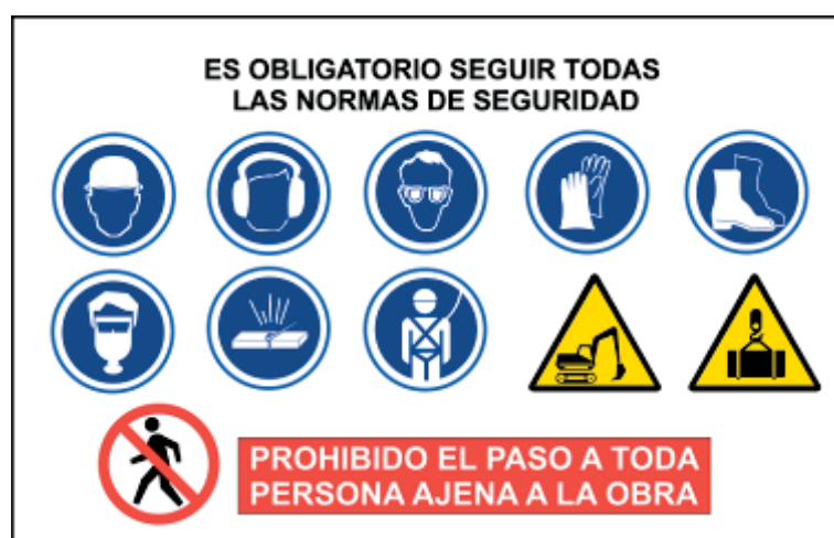
Cartel indicativo de riesgos en acceso a obra.
