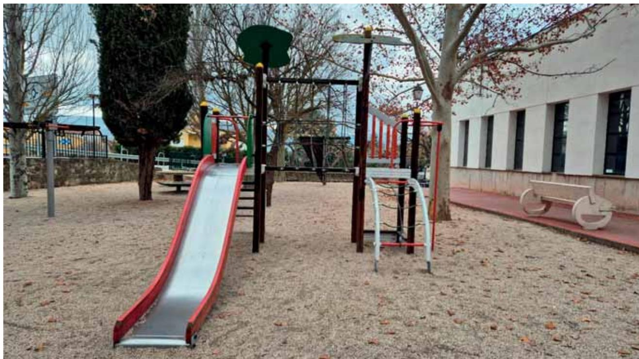
FOTO 5. Conjunto 2 torres con tobogán, puente tibetano y trepa. Sobre pavimento de gravilla de canto vivo.
